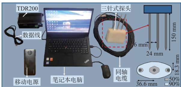
图 21 TDR 原位测试设备图 [100]
